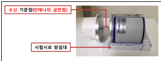
[그림 8] 송신 안테나의 수평장착 상태
