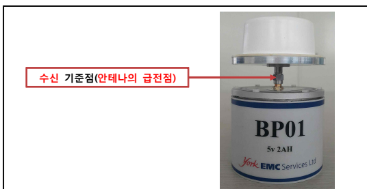
[그림 9] 송신 안테나의 수직 장착 상태
